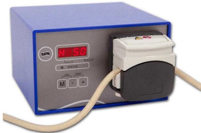
Les B&S DIGI Pompes péristaltiques de SEM Waterbehandeling sont des pompes doseuses universelles qui ont été désignées spécialement pour le dosage de produits chimiques en toute sécurité. La pompe se caractérise par de nombreux avantages pratiques tels que le pompage des liquides avec des bulles d'air. Le B&S DIGI Pompe péristaltique peut être commandée par tout équipement de mesure et de réglage.
