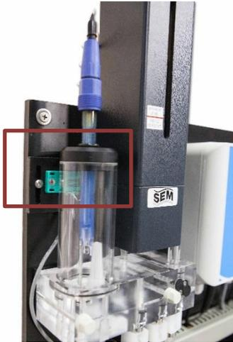
Le schéma de raccordement suivant montre comment raccorder le capteur d'eau de mesure. Retirez la jarrettière installée par défaut entre + et S sur l'entrée de circulation.
